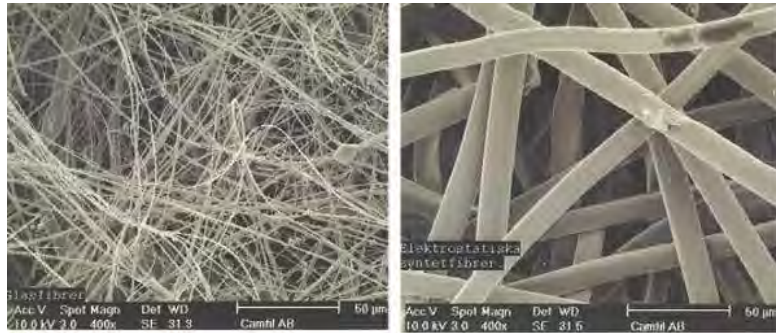
玻璃纤维滤料 (大量的细纤维)
