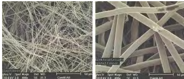
玻璃纤维滤料 (大量的细纤维)
